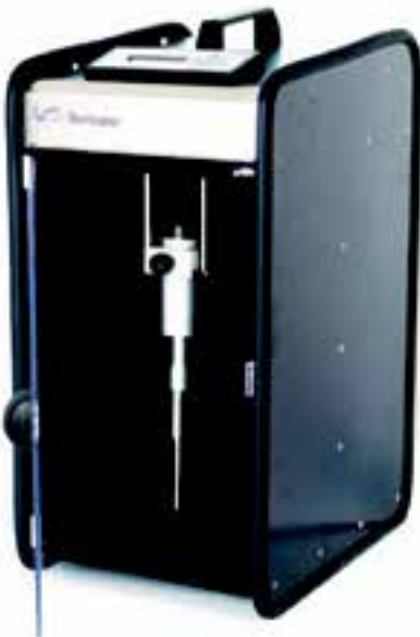
Peynir ve Krema numunelerinde analiz için ultrasonik numune homojenizasyon sistemi
