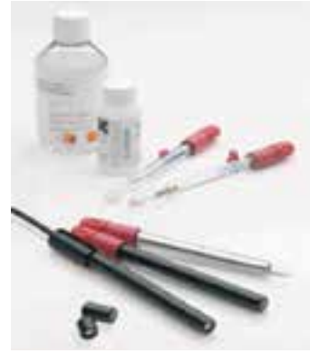
İon selektif probalar ve referans çözeltiler.
